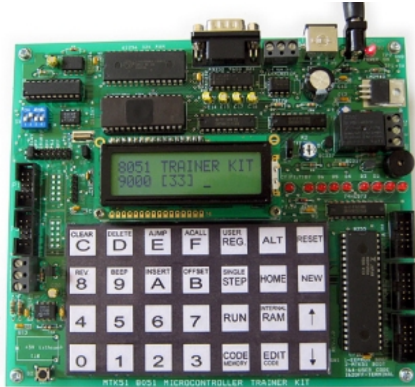
Fig. 1-1. MTK51 8051 Microcontroller Trainer Kit
