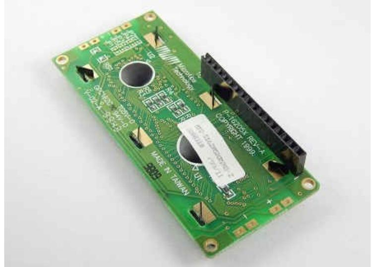
Note : 1 - L'installation de l'écran LCD doit être effectuée lorsque le kit est hors tension !
