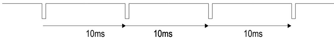
NOTE : La touche TEST, utilisera l'impulsion de 10 ms pour effectuer un comptage binaire à une fréquence de 100 Hz.
