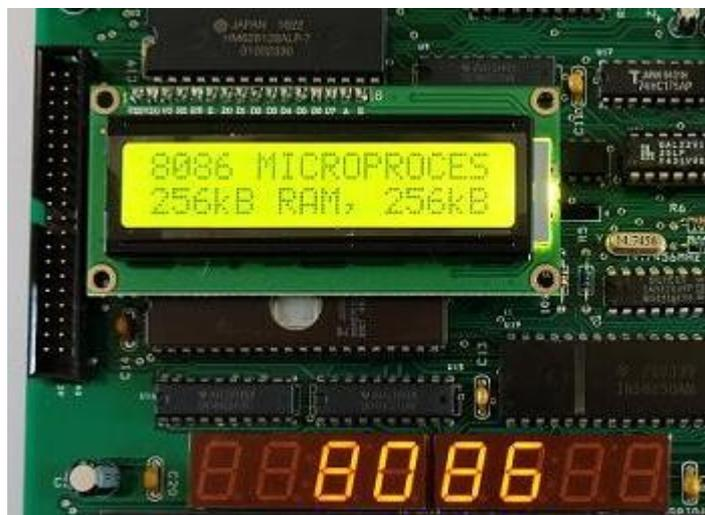
**Remarque : L'insertion ou le retrait du module LCD doit être effectué lorsque le kit est hors tension.**
